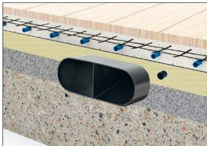
Kanał płaski częściowo w warstwie wyrównawczej i wylewce ze zbrojeniem
